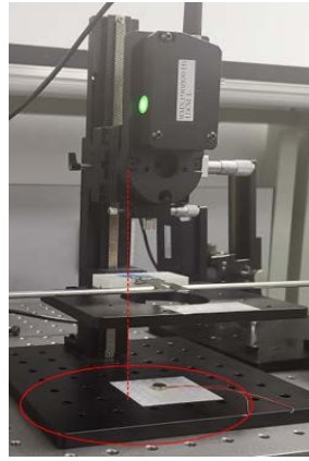
图 1：挚感光子实验室用-手机马达测量装置
